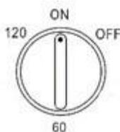
Hvis timeren (tidsindstillingsfunktionen) er indstillet, stopper ventilatoren automatisk på det indstillede tidspunkt, dog senest efter 120 minutter. Denne timer betjenes ved at dreje timer-kontakten med uret frem til den ønskede tidsindstillingsposition.
