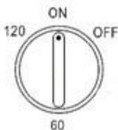
Si le minuteur a été réglé, le ventilateur s'arrêtera automatiquement au terme de la durée réglée, le maximum étant de 120 minutes. Pour activer le minuteur, tourner l'interrupteur dans le sens des aiguilles d'une montre et le positionner sur la durée souhaitée.
