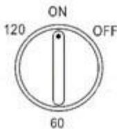
Ako je tajmer postavljen, ventilator se automatski zaustavlja u vrijeme u koje je postavljen no unutar maksimalno 120 minuta. Za rad s ovim tajmerom, molimo vas da okrenete gumb tajmera u smjeru kretanja kazaljki na satu u željeni položaj za odbrojavanje.
