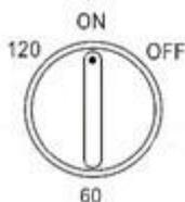
Pokud byl časovač nastaven, větrák se automaticky zastaví ve vámi nastaveném čase, který lze nastavit na maximálně 120 minut. Pro zprovoznění časovače prosím otáčejte přepínačem časovače ve směru otáčení hodinových ručiček do požadované polohy načasování.
