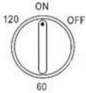
Zamanlayıcı ayarlanmışsa, vantilatör ayarladığınız zamanda duracaktır fakat maksimum süre 120 dakikadır. Zamanlayıcıyı çalıştırmak için, zamanlayıcı düğmesini saat yönünde çevirerek istediğiniz konuma getirin.
