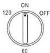
Если установлен таймер, вентилятор автоматически отключится, как только истечет время таймера. Максимальное время таймера 120 минут. Чтобы установить таймер, поверните переключатель таймера по часовой стрелке в нужное положение, соответствующее времени обратного отсчета.
