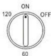
Ha az időzítő be van állítva, a ventilátor a beállított idő letelte után (legfeljebb 120 perc) után kikapcsol. Az időzítő használatához fordítsa el a gombot az óramutató járásának irányába a kívánt időértékhez.
