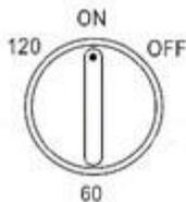
Hvis tidsbryteren settes, vil viften automatisk stanse på den tiden som er innstilt, med en maksimumtid på 120 minutter. For å bruke tidsbryteren, dreie tidsbryterknappen til høyre for å stille inn ønsket tid.
