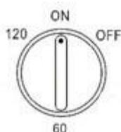
Ако е зададен таймер, вентилаторът автоматично ще спре за времето, което е било настроено, но максимално за 120 минути. За да използвате този таймер, завъртете превключвателя на таймер по часовниковата стрелка до желаната позиция.
