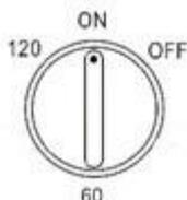
Si se ha programado el temporizador, el ventilador se detendrá automáticamente a la hora fijada, pero dentro de 120 minutos como máximo. Para hacer funcionar el temporizador, gire el interruptor del temporizador hacia la derecha hasta la posición deseada.
