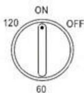
Wenn die Zeitschaltuhr eingestellt ist, wird der Ventilator automatisch nach der von Ihnen eingestellten Zeit, aber nach höchstens 120 Minuten, ausgeschaltet. Um die Zeitschaltfunktion zu nutzen, drehen Sie den Zeitschalter bitte im Uhrzeigersinn auf die gewünschte Laufzeit.
