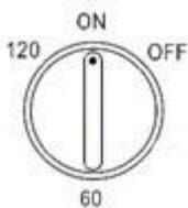
Ako je mjerač vremena postavljen na neku vrijednost, ventilator će se automatski zaustaviti po isteku odgovarajućeg vremenskog perioda, ali najdalje u za 120 minuta. Mjerač vremena postavljate okretanjem dugmeta u smjeru kretanja kazaljki na satu, do željenog položaja.
