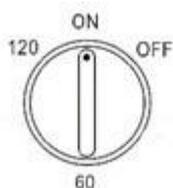
Ja ir uzstādīts taimeris, ventilators automātiski apstāsies pēc uzstādītā laika, bet ne vēlāk kā pēc 120 minūtēm. Lai lietotu taimerī, lūdzu, pagrieziet taimera slēdzi pulksteņrādītāja kustības virzienā uz vēlamo laika atzīmi.
