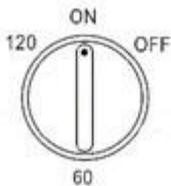
Als de timer is ingesteld, zal de ventilator automatisch stilvallen op de tijd die u hebt ingesteld, maar binnen de 120 minuten van het maximum. Om de timer te bedienen, draait u de timerschakelaar in de richting van de wijzers van de klok in de gewenste timerpositie.
