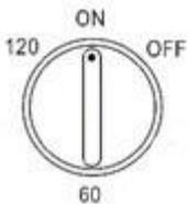
Kui taimer on seadistatud, seiskub ventilaator automaatselt seadistatud aja möödumisel; aja saab seadistada kuni 120-le minutile. Taimeri töölehakkamiseks pöörake taimeri lülitit päripäeva kuni soovitud asendini.
