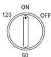
Om timern är inställd stannar fläkten automatiskt efter den tid du ställt in, men maximalt efter 120 minuter. För att ställa in timern vrider du timerbrytaren medurs till önskad tidsposition.
