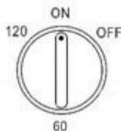
Una volta impostato il timer, il ventilatore si fermerà automaticamente all'ora impostata entro 120 minuti. Per mettere in funzione questo timer, girare l'interruttore in senso orario alla posizione desiderata.
