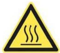
Ole hyvä äläkä kosketa pintoja käytön aikana. Laitteen näkyvissä olevien pintojen lämpötila saattaa nousta käytön aikana korkeaksi.
