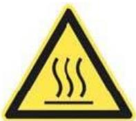
Raak het oppervlak a.u.b. niet aan tijdens gebruik. De temperatuur van toegankelijke oppervlakken kan erg hoog worden wanneer het apparaat aan staat.
