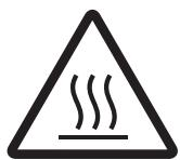
Die Toastoberflächen, sowie die Seiten und das Oberteil des Geräts werden sehr heiß. Nicht anfassen. Verbrennungsgefahr! Nur am Handgriff anfassen. Das Gerät muss stets in waagerechter Position in Betrieb genommen werden.
