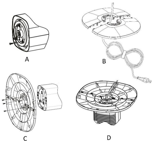
1. Entfernen Sie die 3 Schrauben aus der Drehscheibe. (A)
