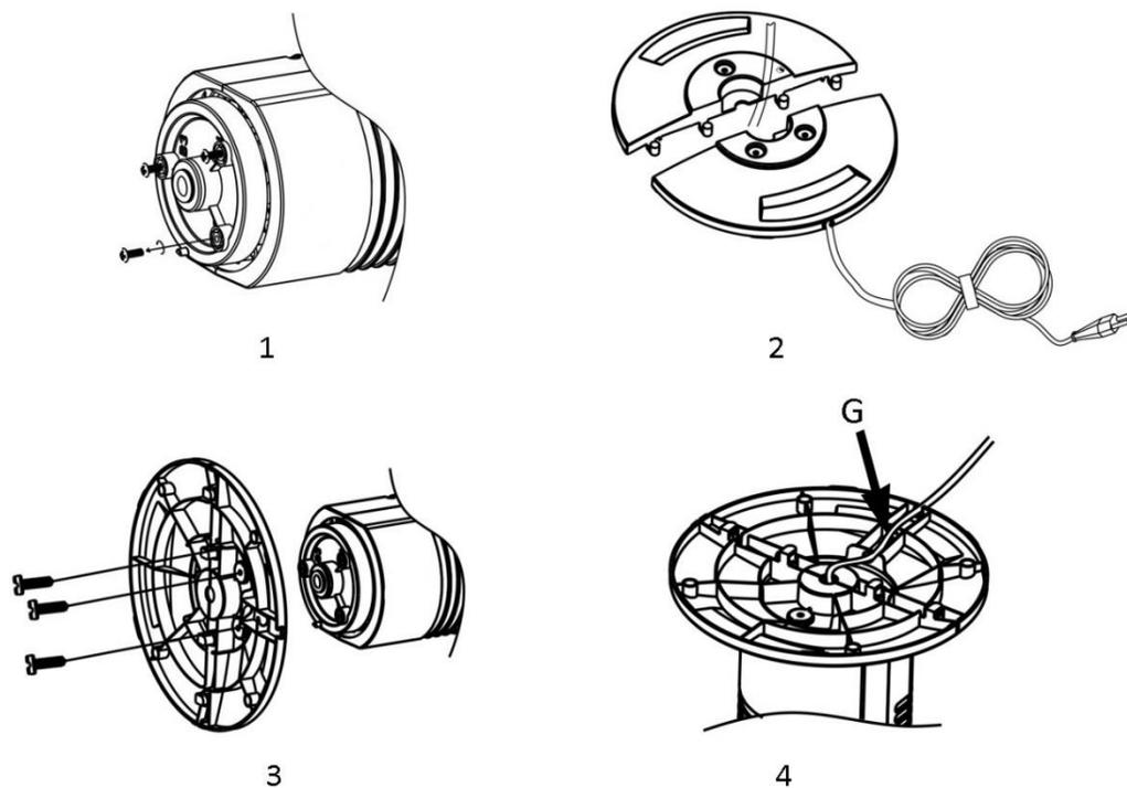
1. Die 3 Schrauben aus der Drehplatte herausschrauben.
