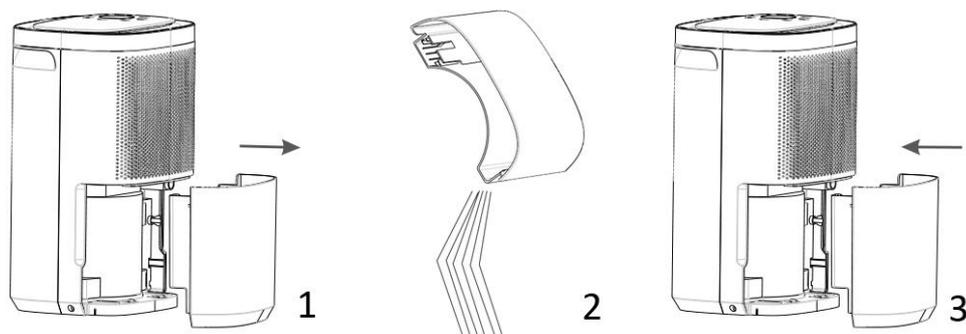
1. Ziehen Sie den Wassertank aus dem Gerät.
