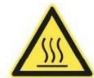
No toque la superficie durante el uso. La temperatura de las superficies accesibles podría ser alta durante el funcionamiento del aparato.
