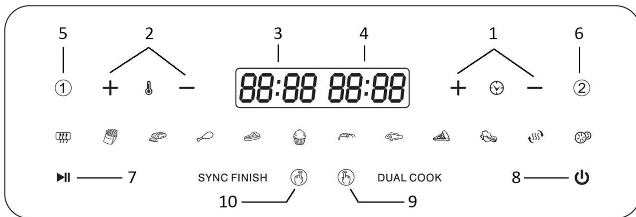
1. Réglage de la minuterie (Appuyez sur « + » ou « - » pour régler la minuterie de 1 à 60 minutes)
