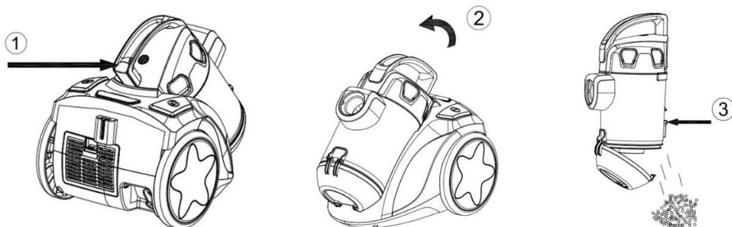
**De motorfilter (Hepa filter), stoffilter en luchtauitlaatfilter (Hepa filter) verwijderen & reinigen.**
