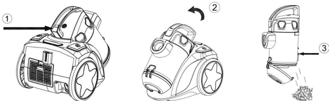
**Retirer et nettoyer le filtre pré-moteur (filtre HEPA), filtre à poussières et le filtre de sortie d'air (filtre HEPA)**
