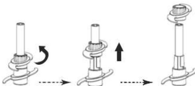
2. Plasser og roter beholderlokket på beholderen (merk deg utbulningen og sporet). Plasser motorenheten på beholderlokket. Forsikre deg om at kanten på motorenheten og beholderlokket er helt korrekt justert.
