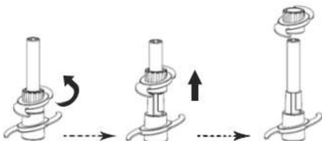
2. Den Deckel auf den Behälter aufschrauben (auf die Verjüngung und Erhöhung achten). Den Antriebsmotor auf den Behälterdeckel aufsetzen. Darauf achten, dass die Kante des Antriebsmotors und der Behälterdeckel nicht verkantet sind.
